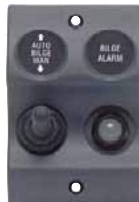
900-BA Panel pompy żęzowej: 1 przełącznik wł./wył./wł. do sterowania auto i manualnego; 1 dioda ostrzegawcza i alarm do sygnalizacji wysokiego poziomu wody. (Wyłącznik pływakowy (pływak) zamawiany osobno jako pozycja SB1-FS)
