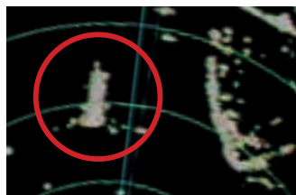
Komercyjna antena radaru 25kW 8,5' łączy obiekty.
